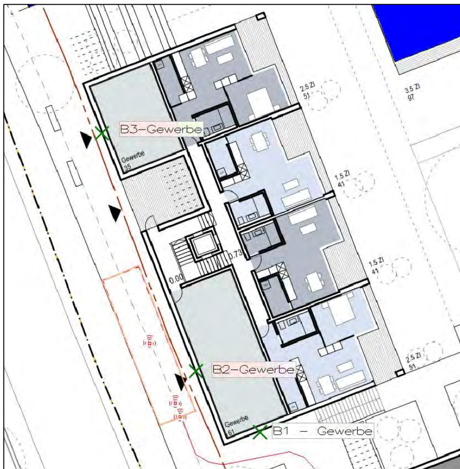
Abb. 2: Lage der Beurteilungspunkte EG Haus B (Haus C = EG Volg, nicht lärmempfindlich)
