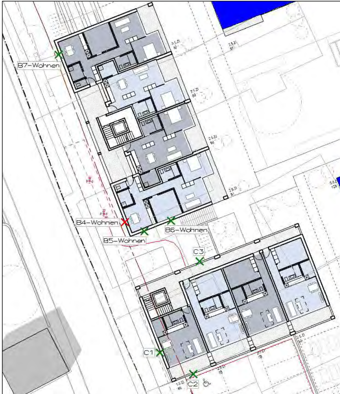
Abb. 3: Lage der Beurteilungspunkte 1. OG Haus B und C (rot => PW, grün =< PW)
